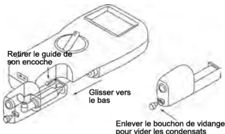
Dévisser soigneusement le bouchon de la partie inférieure du boîtier du déshydrateur. Vider les condensats dans un endroit approprié, il faut faire attention car les condensats pourraient être acide. Si les condensats coulent sur la peau ou sur les vêtements, il faut nettoyer immédiatement avec de l'eau fraîche, voir un médecin si vous vous sentez mal. Vous assurez que le bouchon soit remis avant de faire les tests de combustion.
