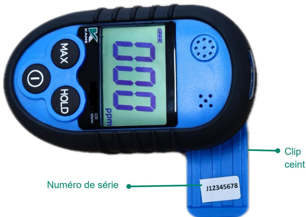
Utilisez la partie numérique du numéro de série pour coupler votre analyseur KANE LINK. KANE LINK nécessite un numéro de série à 10 chiffres. S'il est plus court, utilisez des 0 devant le numéro de série pour créer un numéro de série à 10 chiffres.
